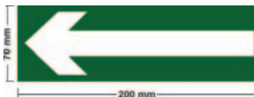
Figura 2 – Detalhe da sinalização tipo C-1
