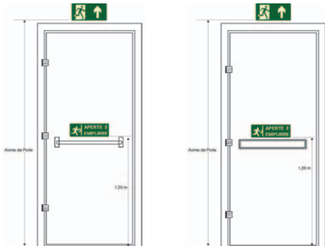
Figura 5 - Sinalização de portas com barras antipânico (modelos 1 e 2)
