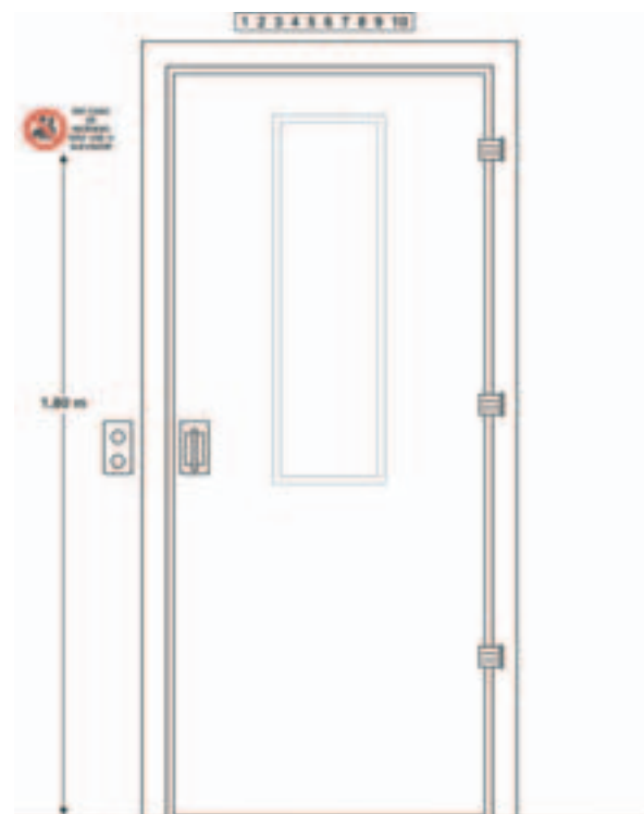
Figura 4 - Sinalização de elevadores (vista da escada)
