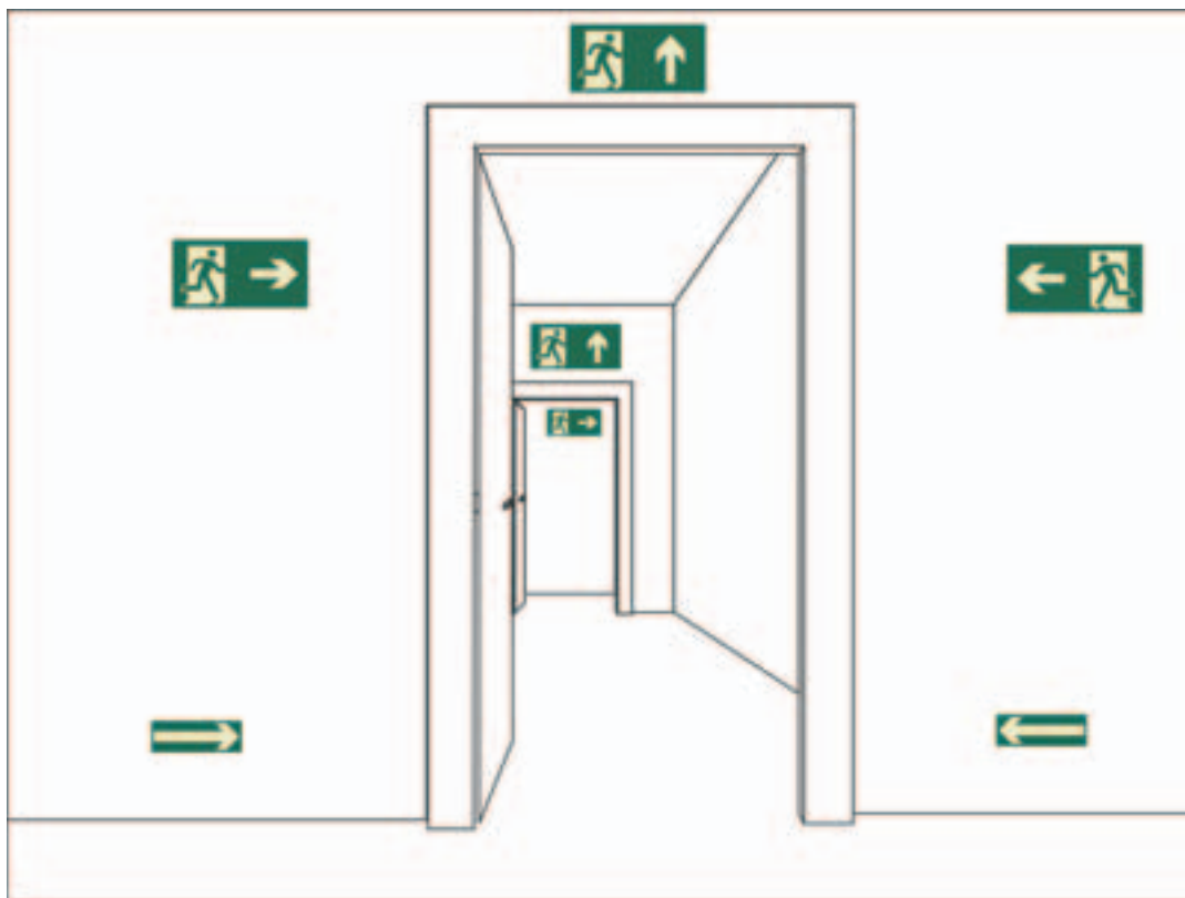
Figura 11 - Sinalização de saída sobre paredes e vergas de portas
